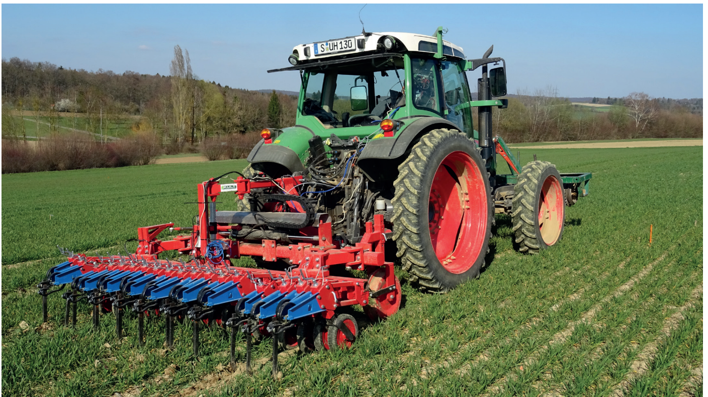
Bild 1: Kamera-gesteuerte Hacke in eng gesättem Getreide
